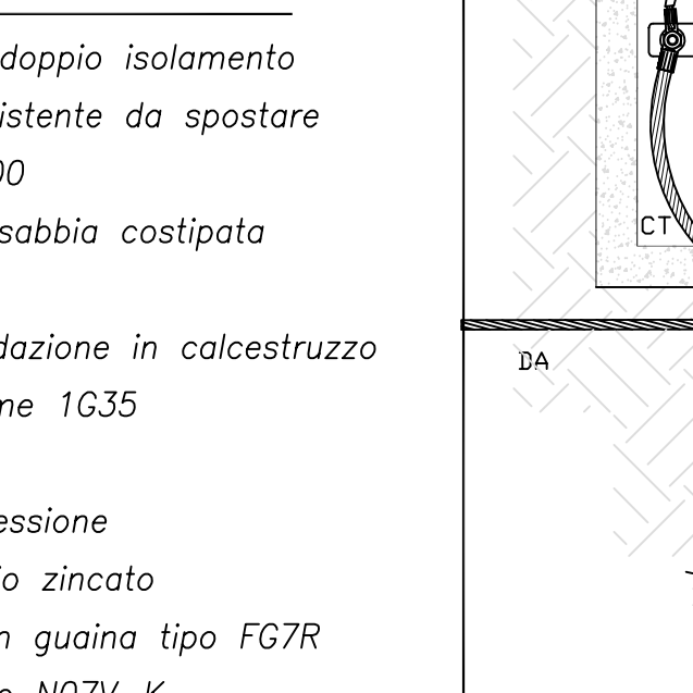
Particolare per spostamenti linee telecom scala 1:10
