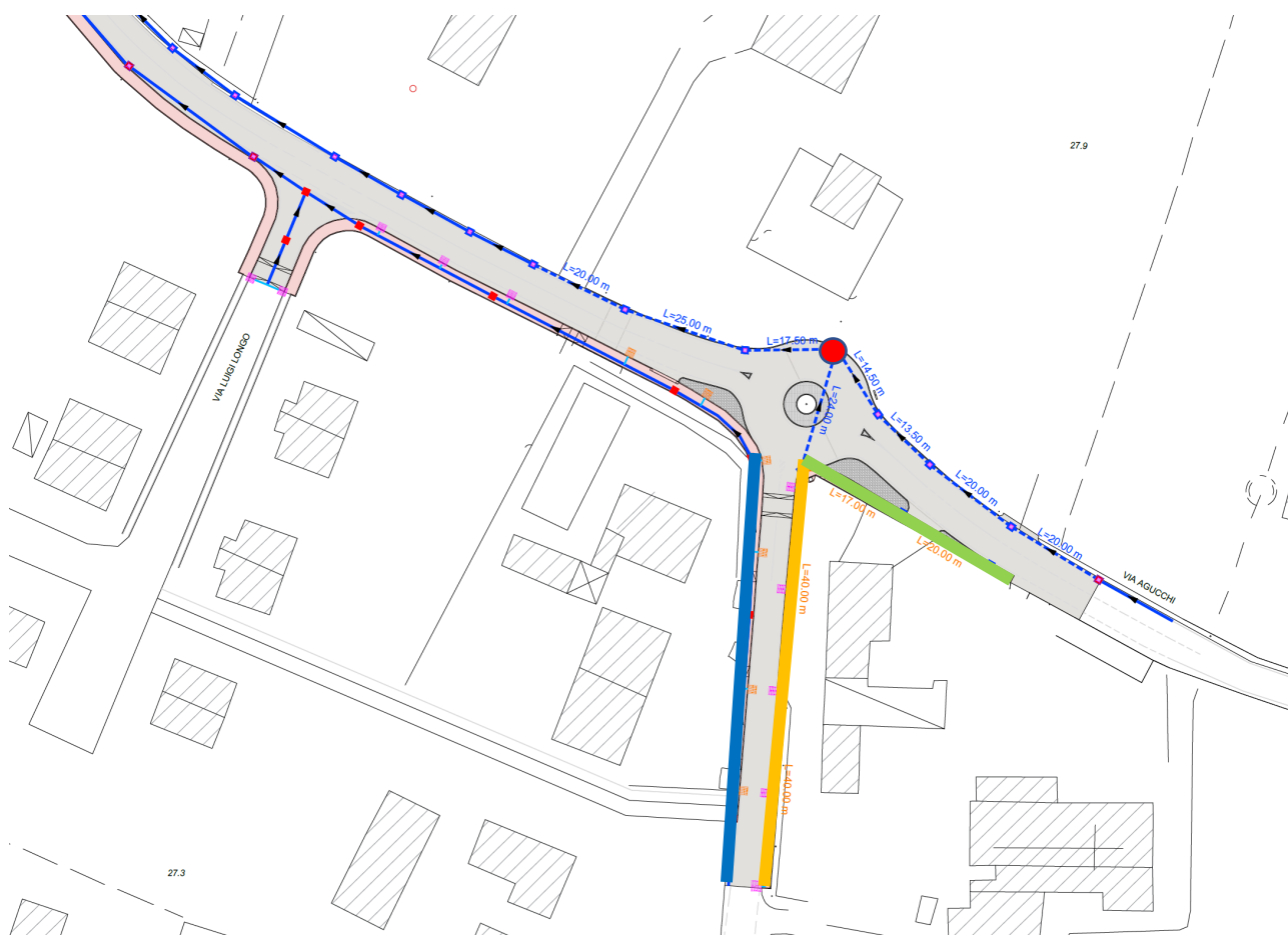
Figura 5.1: Sistema di drenaggio intersezione via Bondanello e via Agucchi
