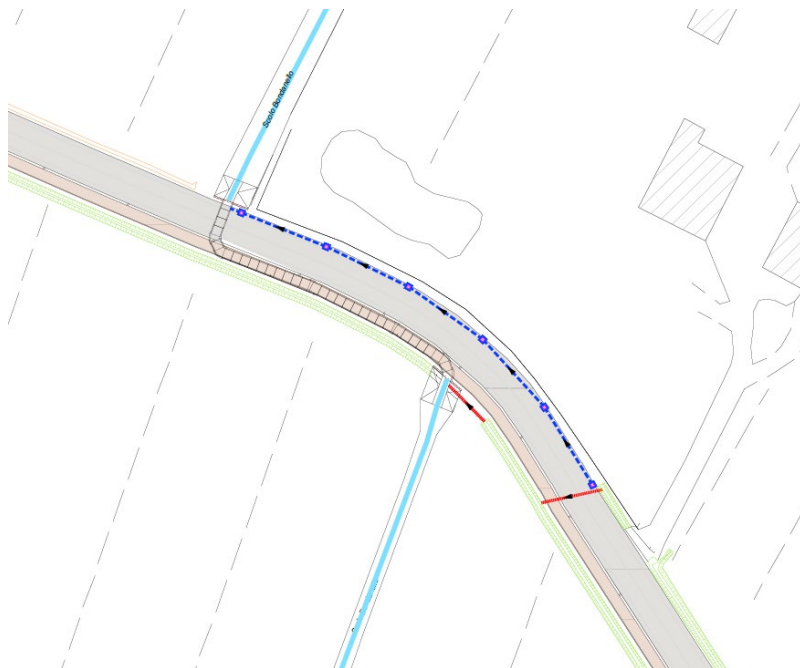
Figura 5.4: Tratto di tombinatura dello scolo Bondanello
