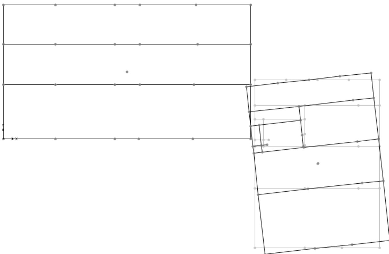
Modo di vibrare 5 ( T = 0,3022 s): edificio Est, torsionale.
